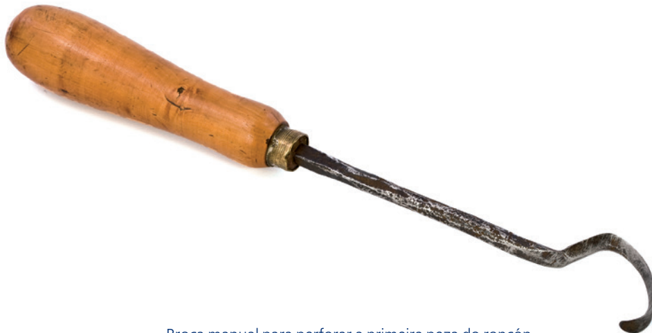
Broca manual para perforar a primeira peza do roncón Ferramenta para escavado interior da copa do roncón
